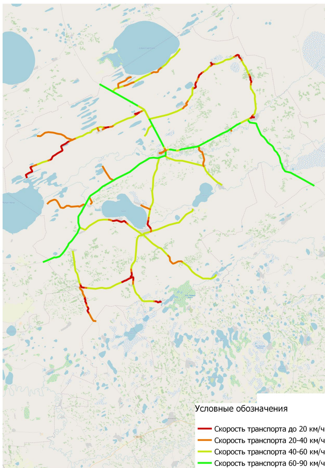
Рисунок 4.2 - Картограмма распределения скорости транспортных потоков при базовом варианте проектирования в расчетный пиковый час, км/ч
